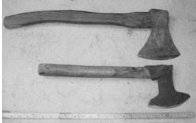
Bild t.v. Huggspåret är betydligt rakare än eggen! Bila från Hjärsås som användes med den ”plana” sidan vänd från stocken och då fungerade som en knivslipad bila. Bild t.h. Två mindre bilar, asymmetriskt slipade, den undre från Hjärsås.
