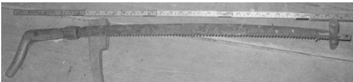
Klyvtandad sav från Strönhults gård, Örkened sn, Göinge härad. Pistolgreppet är fast monterat medan det tvärställda handtaget, påminnande om handtaget på en oxhyvel, är fastkilat för att enkelt kunna avlägsnas. Totallängd 84 cm, bredd ca 35 mm, ca 16 tänder på 10 cm. Ryggen tunnare och tänderna svagt skrånka.
