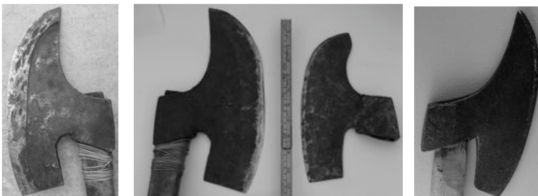
Bild t.v. Baksida på bila med påsvejsat stål. Bild mitt. Samma bila framifrån och en snarlik vänsterbila från Färingtofta. Bild t.h. Bila som har ägarinskriftion PNS 1885. Denna bila tillhör Gislövs smidesmuseum.
