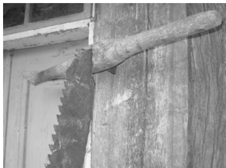
Bild t.v. Killebodasaven med tänder som vänder på mitten. Bild mitt. Tångarna är svejsade och nitade. Originalskaftet är i svarvadek som enkelt kan lossas med en bläja (kil). Bild t.h. Timret är skurit med Killebodasaven och ska användas som lejd på Ballingstorpsgårdens undantag.
