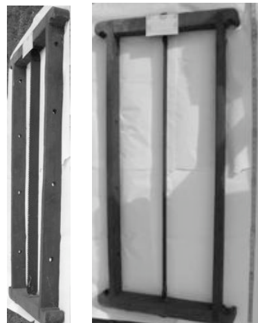
Bild t.v. Timmer uppplagt för att klosavas (Gustafsson 1928 LUF G:9). Bild mitt. Foto på klosav, (Gustafsson, 1928: LUF G:9). Bild t.h. på klosav i Bondrumsgården observera hålen på sidostyckena.
