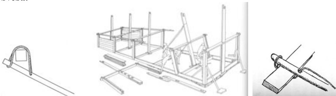
Bild t.v. ”Svøbelægte” efter (Jørgensen 1946:171). Bild mitt. Användning av sveba vid resning av öländsk byggnad efter (Henriksson 1996:304). Bild t.h. norsk hempingstang efter (Berg 1972:87).
